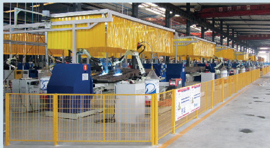
Автоматизированный сварочный цех
